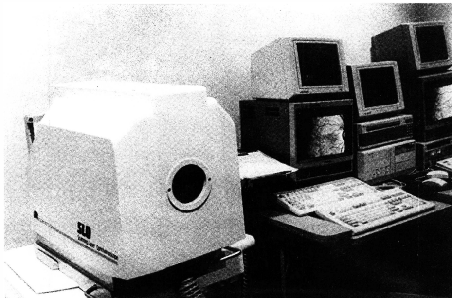
Foto 1: Oftalmoscópio de rastreamento a laser, Rodestock modelo 101, acoplado a um microcomputador, monitores de vídeo, videocassete e impressora de ação térmica.
